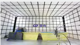
高速电机/启动发电机 EMC测试系统 EMC test system for high speed motor/heuristic motor
