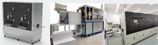
磁瓦表面缺陷智能分选机
